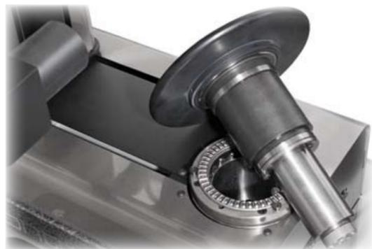
Mandrino rotante intercambiabile con freno pneumo-meccanico della rotazione. Due gabbie di sfere precaricate permettono precisioni di concentricità entro i 2 µm.
