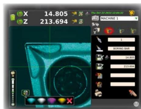
Funzione di ispezione per un controllo accurato dello stato dell'utensile. Possibilità di aumentare o diminuire l'intensità luminosa per una migliore visibilità.
