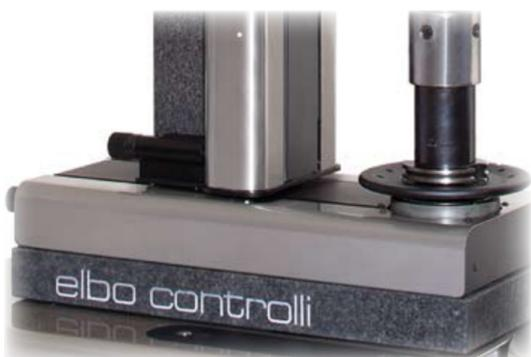
Granito naturale impiegato sia per la colonna che per la base. La stabilità termica del materiale permette di collocare la macchina in officina. Impiego di acciaio inox per la meccanica
