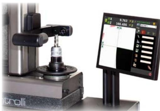
Ampio display touch-screen da 15" per un ottimale visualizzazione degli utensili ed una semplice gestione delle funzioni macchina di misura.
